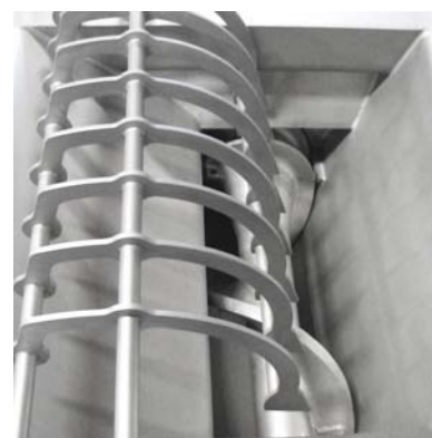
Шнек и направляющий блок для замороженного сырья
